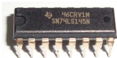
Figura 1. Invólucro DIP-14 do circuito integrado SN74LS145N [4].
